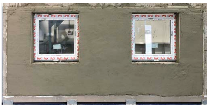
Bild 1 Aufgemauerter Probekörper mit einbruchhemmenden Fenstern Masonry test wall with installed burglary-retarding windows
