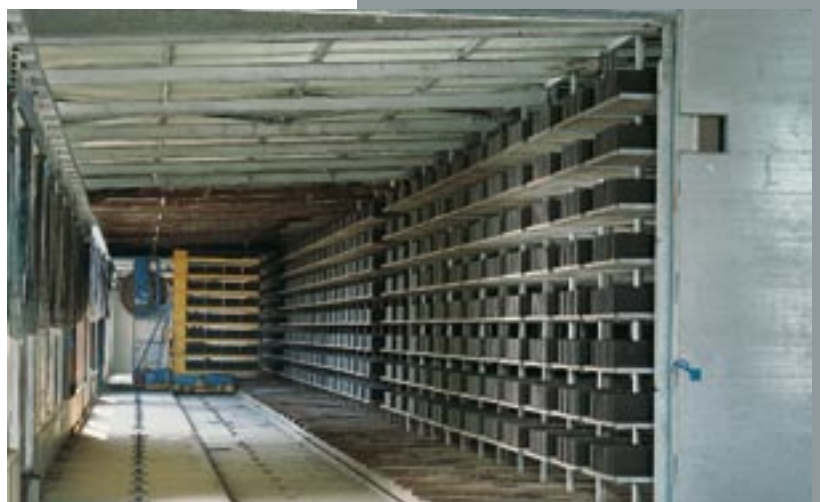
Mittels vollautomatischer Schiebebühnen gelangen die fertigen Steine in die Regal-Trockenkammer. Hier wird die Hydratationswärme, die beim Abbinden des Zementes entsteht, zur Trocknung der Steine benutzt. Trockenzeit ca. 1-3 Tage.
