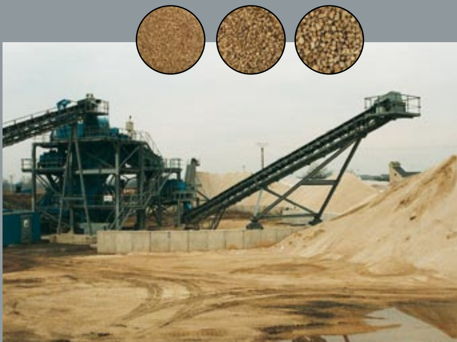
In der Bims-Waschanlage wird das Waschwasser im Kreislauf gefiltert und mit geringen Mengen Frischwasser ergänzt. Sämtliche aufbereiteten Rohstoffe gelangen in die weitere Produktion.
